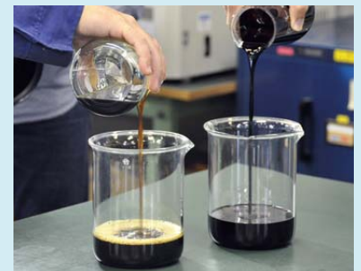
コスモ石油は2014年10月、アメリカからシェール由来のコンデンセートを日本企業で初めて輸入し、油種の多様化も実現しました。コンデンセート(左)は、ガス田から液体分として採取される原油の一種で、超軽質で粘度が低いため泡立ちます。
