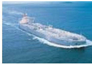
原油の流出を未然に防ぐ ダブルハルタンカー
